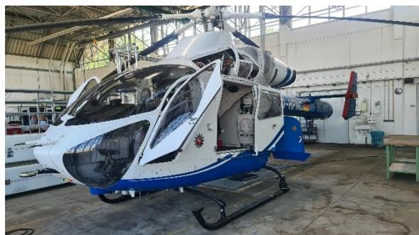
Es gibt einen herausragenden Unterschied zwischen dem neueren Eurocopter von Airbus, der über einen Heckrotor verfügt, und dem älteren McDonnell Douglas, der am Heck durch ein Gebläse mit Druckluft stabil gehalten wird (NOTAR-Prinzip). Wichtig sind beide für die
